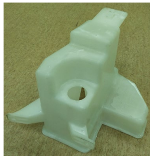
Общий вид детали «Бачок нижняя часть»
