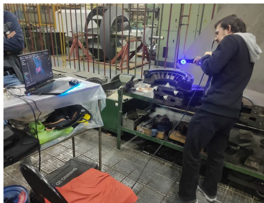
3D-модель на рабочую часть оборудования «Шнек левый»
